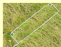
Spillone in acciaio zincato per il trasporto dei geofoni
